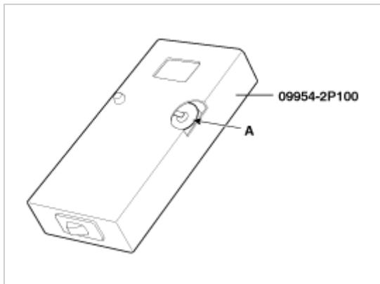
4. 推下测试按钮，如果屏幕上显示“0.00”，表明蓄电池电压小于2V。
